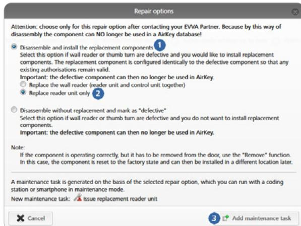
DE Wählen Sie im Dialog „Reparaturoptionen“ unter „Ausbauen und Ersatzkomponenten einbauen“ ① den Radio-Button „Nur Leseeinheit wechseln“ ②. Abschließend klicken Sie auf die Schaltfläche „Wartungsaufgabe hinzufügen“ ③ Die Wartungsaufgabe „Ersatzleseeinheit ausstellen“ wurde erstellt.
