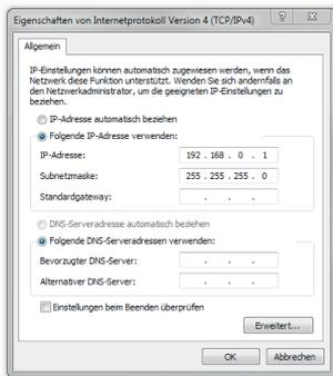
› Konfigurieren Sie nun die **IP-Adresse** und die **Subnetzmaske** des PCs, mit dem Sie die Konfiguration vornehmen.
