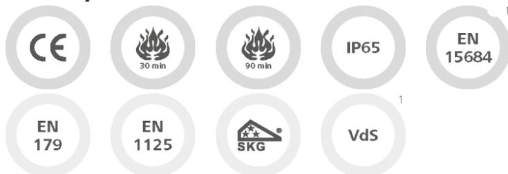
CE-conforme | EN 1634: 30 minutos | EN 1634: 90 minutos | Grado de protección IP65 | EN 15684 | apto para cerraduras según EN 179/1125 (cuando se aplica la función antipánico FAP) SKG | VdS<sup>1</sup>
